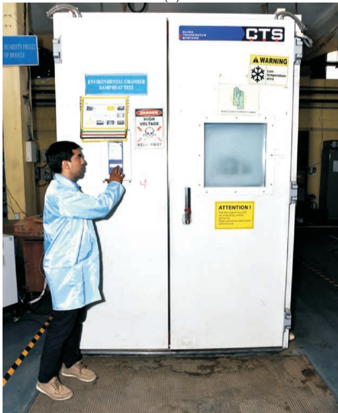
चित्र 4.2 राष्ट्रीय सौर ऊर्जा संस्थान में फोटोवोल्टिक मॉड्यूल परीक्षण उपकरण (क) तापमान नियंत्रित सूर्य सिम्युलेटर, (ख) पर्यावरण कक्ष
