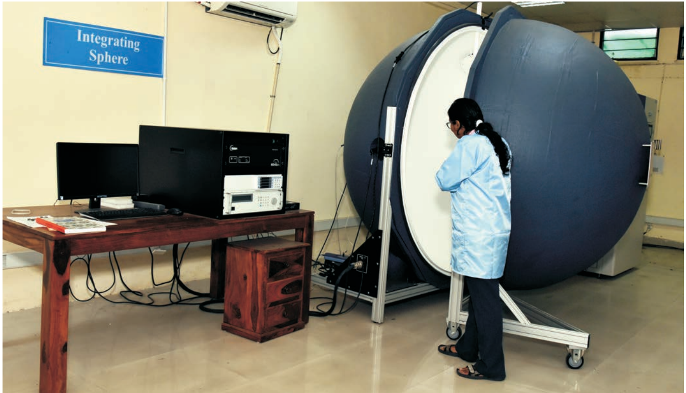
चित्र 4.8 सौर स्ट्रीट लाइट का परीक्षण और तापमान नियंत्रण के साथ क्षेत्र प्रणाली का एकीकरण
