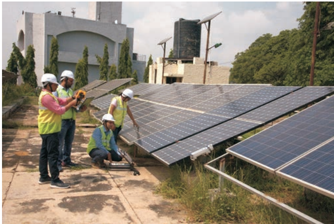
चित्र 4.9 राष्ट्रीय सौर ऊर्जा संस्थान परिसर में फोटोवोल्टिक मॉड्यूल टेस्ट बेड के परीक्षण को दर्शाता है।
