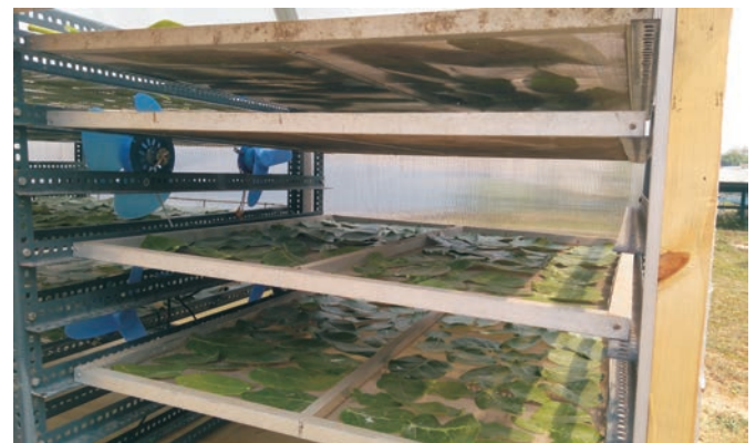
चित्र 5.6 राष्ट्रीय सौर ऊर्जा संस्थान द्वारा विकसित ग्रीनहाउस ड्रायर : (क) लैब स्केल प्रोटोटाइप (ख) लैब परीक्षण
