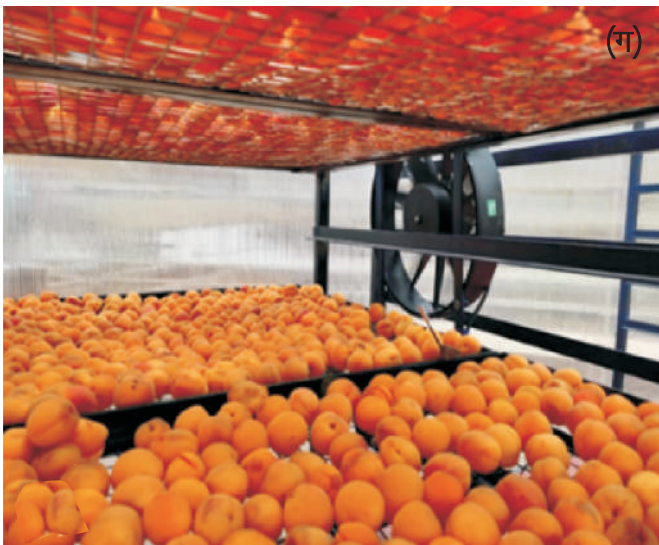
चित्र 2.10: मिनी-ग्रीनहाउस आधारित सौर ड्रायर (क) लद्दाख में फील्ड परीक्षण, (ख) मेश ट्रे पर खुबानी रखना, (ग) ड्रायर के अंदर खिलाए गए ताजा खुबानी, (घ) सुखाने की प्रक्रिया के दौरान खुबानी
