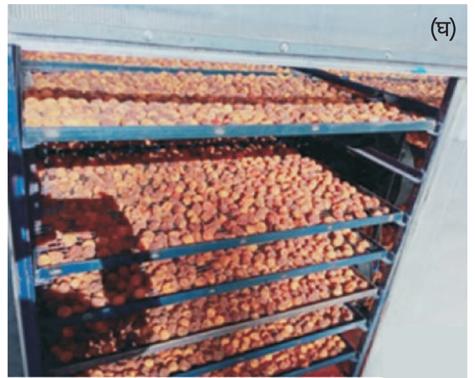
चित्र 2.10: मिनी-ग्रीनहाउस आधारित सौर ड्रायर (क) लद्दाख में फील्ड परीक्षण, (ख) मेश ट्रे पर खुबानी रखना, (ग) ड्रायर के अंदर खिलाए गए ताजा खुबानी, (घ) सुखाने की प्रक्रिया के दौरान खुबानी
