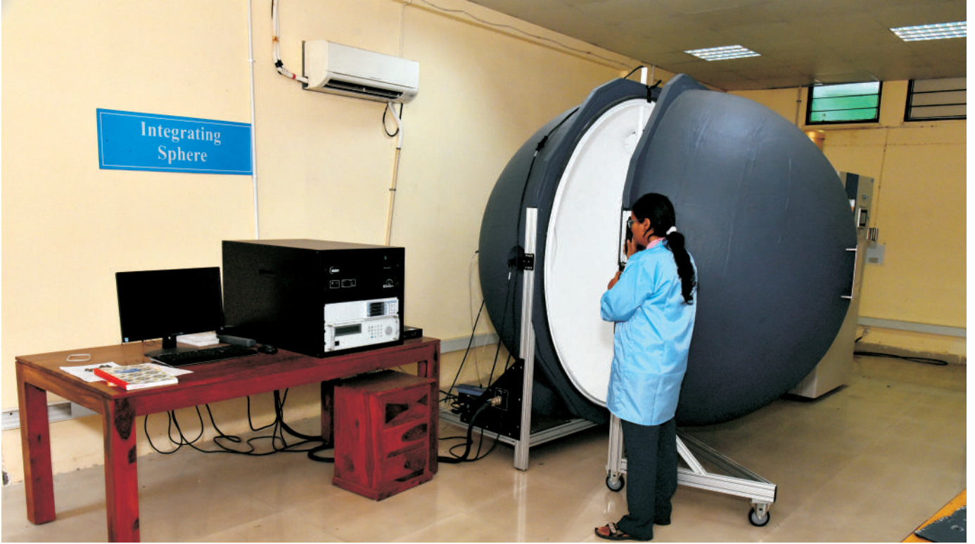
चित्र 3.3: एकीकृत गोले के साथ ल्यूमिनेयर की परीक्षण सुविधा
