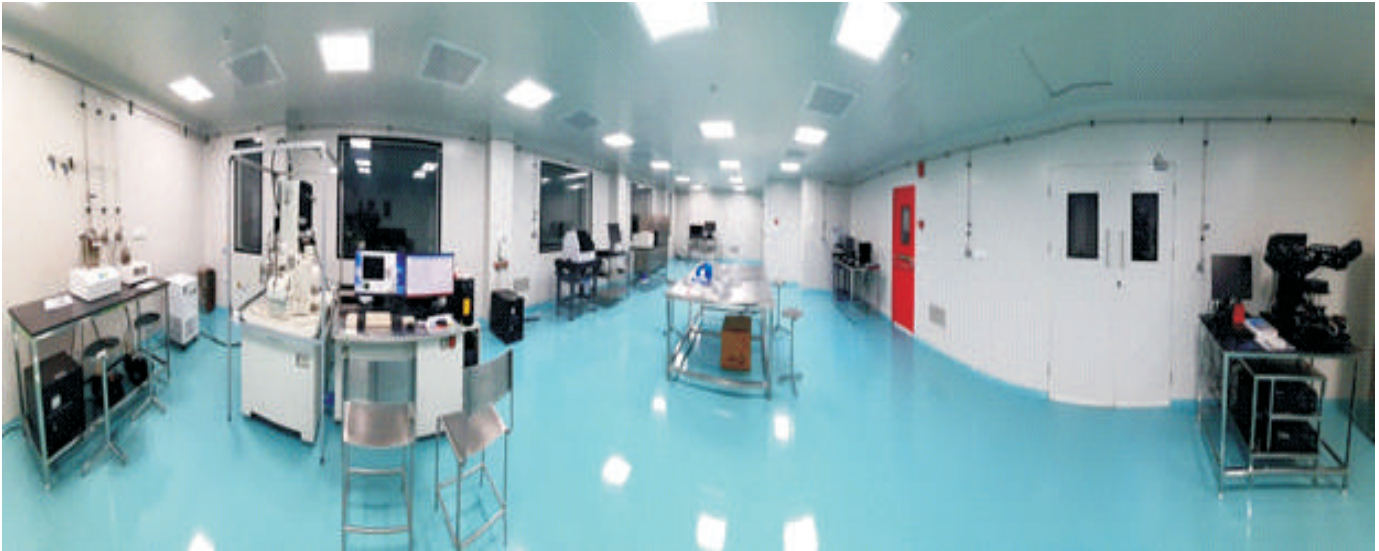
चित्र 2.1: हाउसिंग परीक्षण और निरूपण उपकरणों के लिए आईएसओ वर्ग 8 स्वच्छ कमरा
