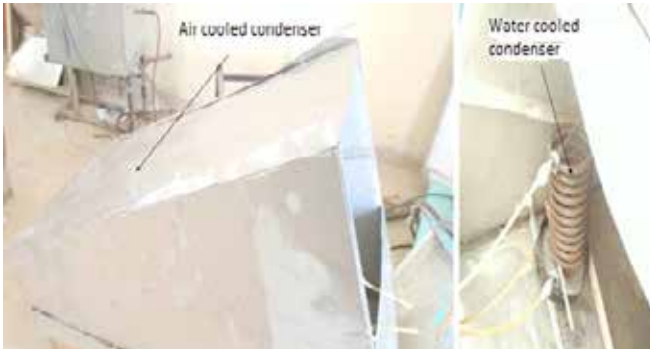
'नाइस' में स्थापित न्यून लागत एकल चैम्बर बहुप्रभावी खारापन दूर करने की प्रणाली
