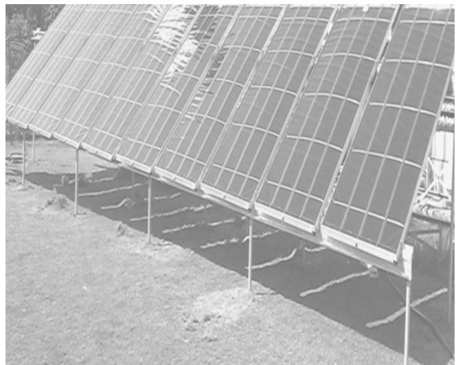
प्लैट प्लेट टाइप सौर जल डिस्टिलेशन प्रणाली की प्रायोगिक आधार पर स्थापना
