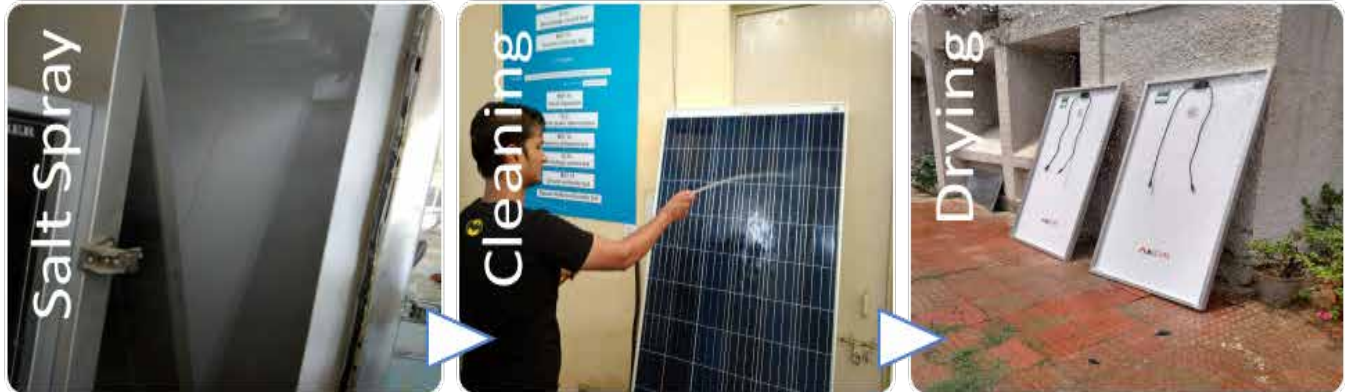
साल्ट स्प्रे के क्रमिक परीक्षण की चित्र द्वारा प्रस्तुति
