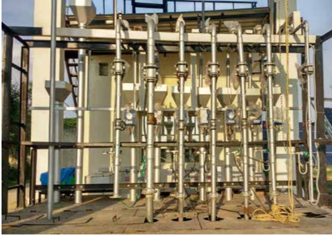
परीक्षण बेड पर पम्प परीक्षण के लिए प्रवाह और दबाव माप तथा नियंत्रण व्यवस्था
