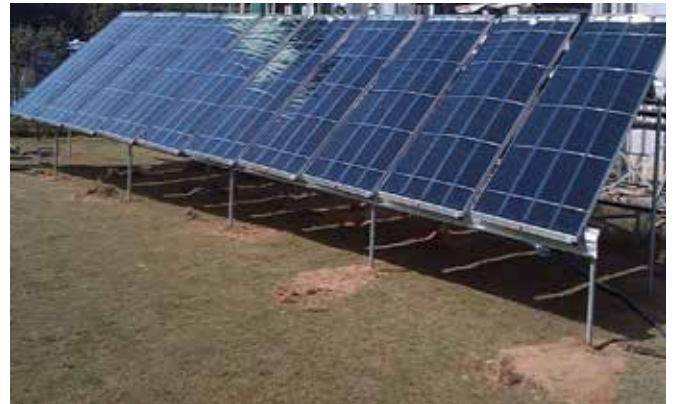
चित्र 5.9 : प्लैट प्लेट टाइप सौर जल आसवन प्रणाली की प्रायोगिक व्यवस्था
