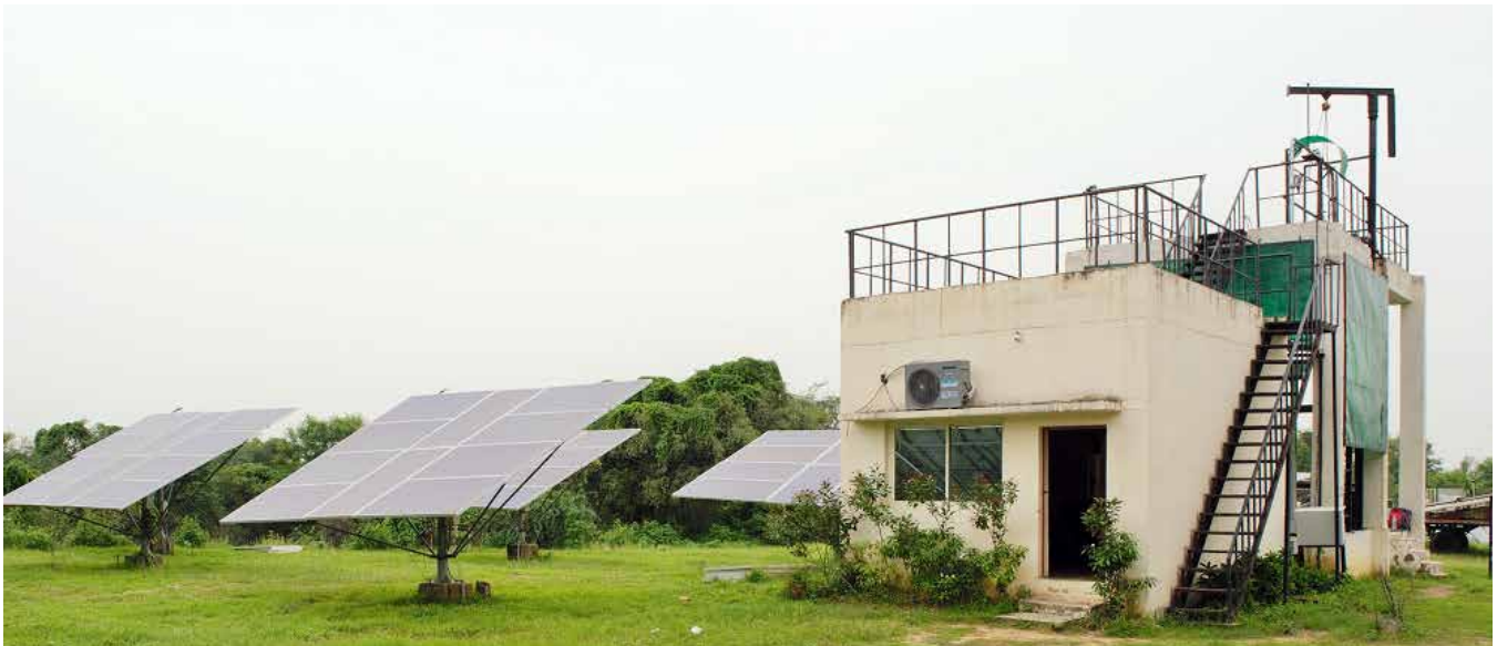
चित्र 4.8 : निष्पादन और डेटा लॉगिंग के लिए नियंत्रण कक्ष सहित परीक्षण स्थल में पंप परीक्षण व्यवस्था
