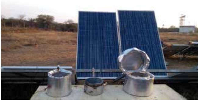
चित्र 6.6 : तापीय बैटरी सहित सौर प्रकाशवोल्टीय आधारित कुकिंग प्रणाली
