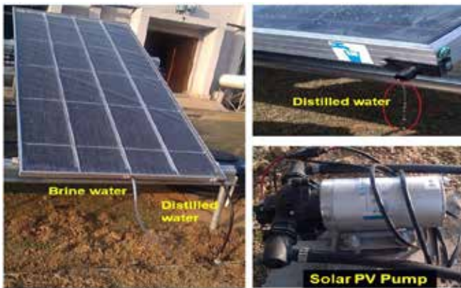
चित्र 5.8 : प्लैट प्लेट टाइप सौर जल आसवन प्रणाली की प्रायोगिक व्यवस्था
