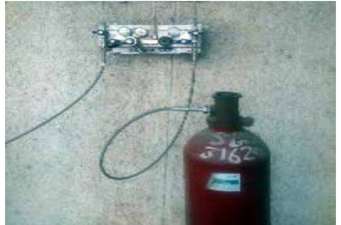
चित्र 7.2 : ईंधन सेल परीक्षण प्रयोगशाला व्यवस्था (प्रयोगशाला के अंदर) और हाइड्रोजन गैस की स्थापना (प्रयोगशाला के बाहर)
