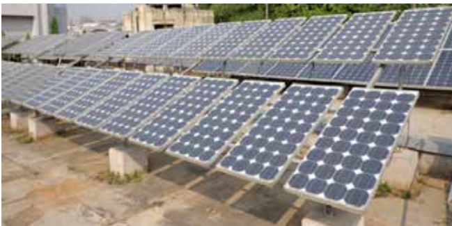
चित्र 4.16 : मोनो सी-एसआई प्रौद्योगिकी प्रकाशवोल्टीय मॉड्यूल के लिए परीक्षण व्यवस्था
