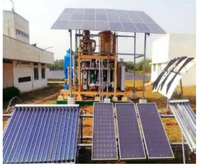
चित्र 5.6 : गर्म पानी/वाष्प आधारित सीएसटी प्रणालियों के परीक्षण के लिए परीक्षण सुविधा
