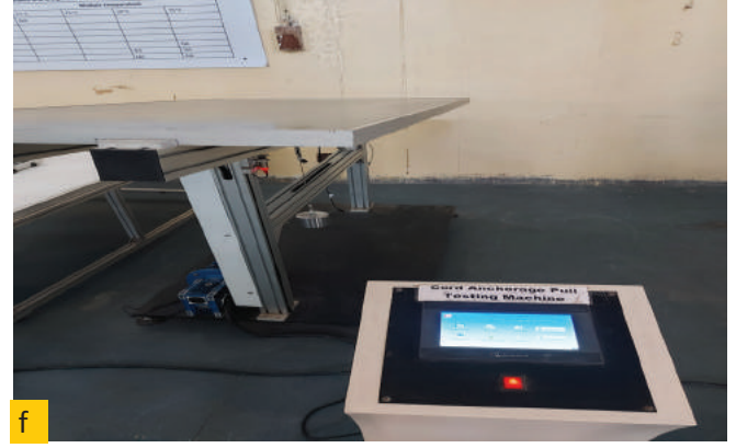
चित्र 4.1 : मॉड्यूल परीक्षण प्रयोगशाला में परीक्षण उपकरण, (क) ईएल छवि सुविधा, (ख) तापन कक्ष, (ग) रोबस्टनेस ऑफ टर्मिनेशन टेस्टर, (घ) कट सस्पेंडी बिलिटी टेस्टर (ङ) मॉड्यूल ब्रेकेज टेस्टर (च) कॉर्ड एंकरेज टेस्टर
