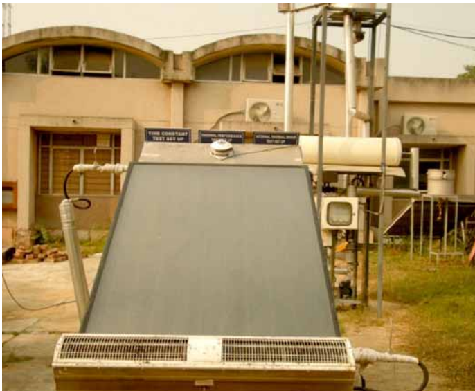
सौर फ्लैट प्लेट कलेक्टर का परीक्षण
