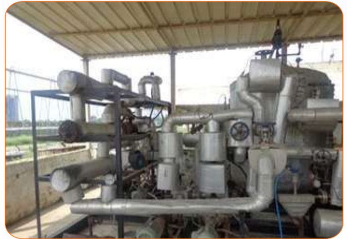
चित्र 3.14 : नाइस में सीएसटी के लिए थर्मिक तरल आधारित परीक्षण की स्थापना
