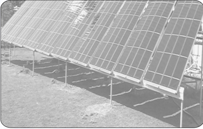
चित्र 3.12 : नाइस में प्लेट प्लेट सौर जल आसवन प्रणाली की प्रायोगिक स्थापना
