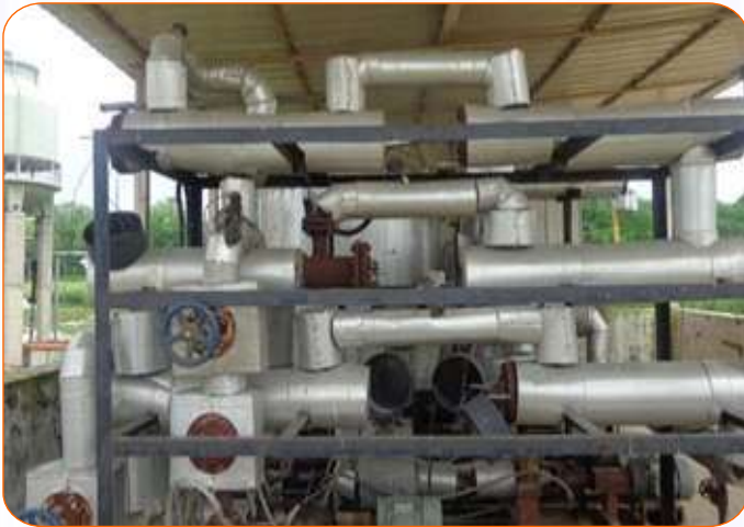
चित्र 3.14 : नाइस में सीएसटी के लिए थर्मिक तरल आधारित परीक्षण की स्थापना
