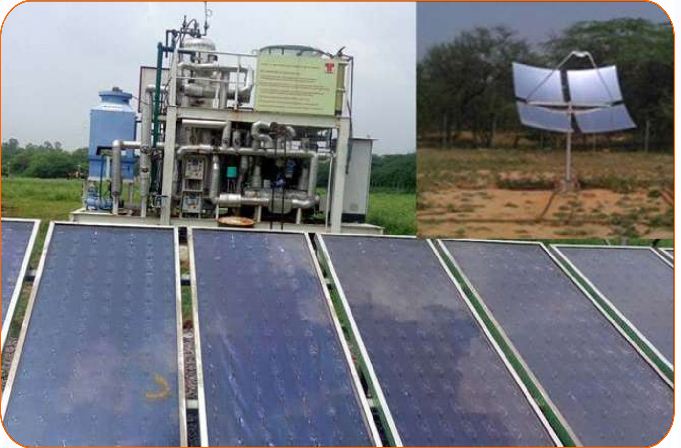
चित्र 3.13 : नाइस में उच्च तापमान के लिए इवेक्युएटिड एफपीसी और सौर डिश का परीक्षण
