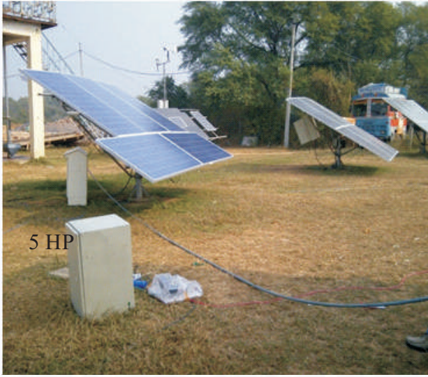
परीक्षण बेड में पंप परीक्षणों के लिए एसपीवी मॉड्यूल की स्थापना
