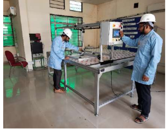
चित्र 3.9: आईईसी 61730 के अनुसार पीवी मॉड्यूल का पिल परीक्षण वर्ष के दौरान नये परिवर्तन:
