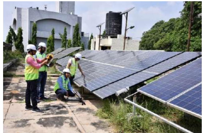
चित्र 3.12: बाहरी क्षेत्र स्थितियों में IV अभिलक्षण और आईआर थर्मोग्राफी के साथ पीवी मॉड्यूल की क्षमता की जांच
